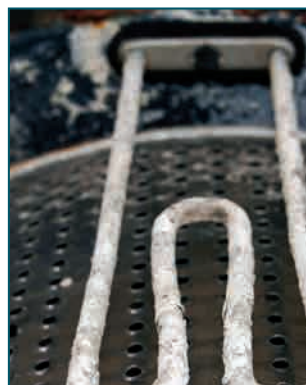
4.4.2. A mosógép fűtőszálán és a csővezetékben lerakódó vízkő
