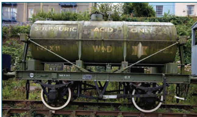
3.3.1. Régi kénsavszállító vasúti vagon
