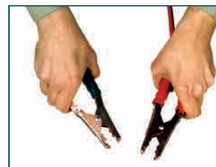
4.8.4. Ha az akkumulátor lemerül, egy arra alkalmas készülékkel újratölthető. Figyeljünk arra, hogy ekkor a negatívhoz a negatív, a pozitívhoz a pozitív pólust csatlakoztassuk!
