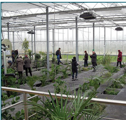
5.3.3. A Dél-pesti Szennyvíztisztító Telepen működik a világ eddigi legnagyobb úgynevezett „élőgépek” technológiájú rendszere, amely egy hatalmas üvegházhoz hasonlít. Itt az élő növényzet gyökérrendszere segítségével növelik a tisztítás hatásfokát
